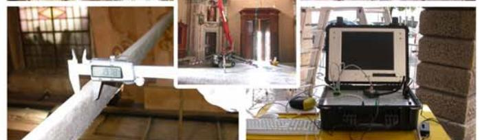
PROVA A TIRO E PROVA DINAMICA SU CATENA
